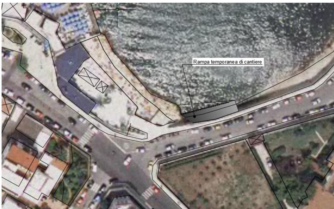
**Foto 9 – localizzazione della rampa di cantiere a servizio del sito d'intervento n. 4**
